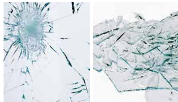
Das Verbund-Sicherheitsglas bricht trotz Gewaltwirkung nicht auseinander.
