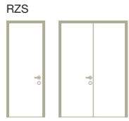
RZS Raumhohe Zarge mit Querteil ohne Kämpfer bis Stocklichhöhe von 2.520 mm (einflügelig, zweiflügelig)
