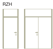
RZH Raumhohe Zarge ohne Querteil mit Kämpfer bis Raumlichte von 2.600 mm (einflügelig, zweiflügelig)
