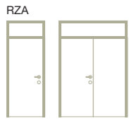
RZA Raumhohe Zarge mit Querteil und Kämpfer bis Stocklichhöhe von 2.520 mm (einflügelig, zweiflügelig)
