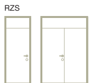
RZS Raumhohe Zarge mit Querteil ohne Kämpfer, jedoch mit Oberblende bis Stocklichhöhe von 2.520 mm (einflügelig, zweiflügelig)
