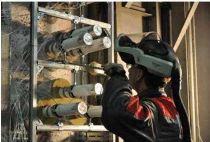
Test bestanden: TECEflex und TECElogo Verbundrohr mit RS 800 Dämmschale bei der Brandschutzprüfung.
