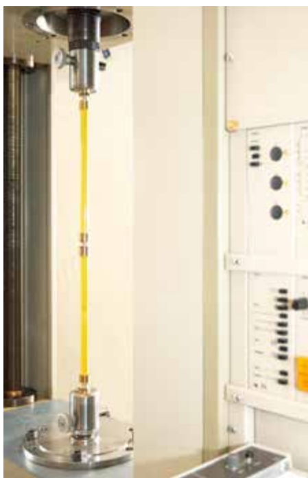
TECEflex Mehrschichtverbundrohr im Zugtest
