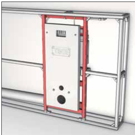
(2) Установка шаблона для отделки отверстия в стене.
